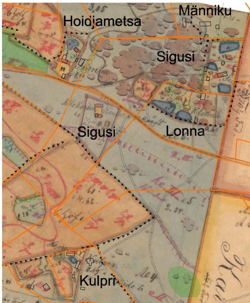
Joonis 31. Väljavõte 1907. a Kihelkonna pastoraadi maade kaardist asetatuna tänapäevasele kaardile (1) hoonete (musta ääristusega riskülikud), (2) katastripiiride (ruuged jooned), (3) kuue katastriüksuse nimega, (4) kiviaedade (kolmnurkadega joon), (5) teedega (topeltjoon) ja (6) rohelisega tänaseks metsastunud alad, mis enne olid osaliselt heina- ja karjamaad. Jooniselt on näha, et tänases asukohas asuvad Sigusi (kaardil nimetatud Sigus ) elamu ja ait, Kulpri ( Keno Kulper ) avana elamu ja ait ning Hoidjametsa ( Tumba ) lauda vundament. Veneküla tuulik (Sigusi lõunapoolsel tükil) ehitati endise kordoni müüdnud hoonete varemetele ( Alde Kordon Häuser verkauft ). Valdavalt on nii teed kui ka kiviaiad säilinud enam kui 100-aastases asukohas. EAA, f 3724, n 5, s 2197, l 6k.
